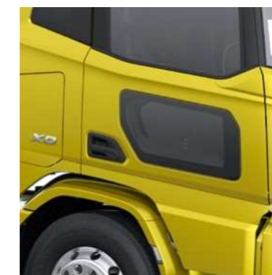
SICHTFENSTER IN DER TÜR
